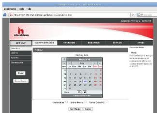
Posee embebido un servidor web para configuración y mantener los usuarios desde un web browser (Chrome, Firefox, Internet Explorer). Las funciones básicas incluyen la puesta en hora del reloj, la configuración de los lectores, los parámetros de comunicación, las acciones, y la obtención de listados de usuarios y marcaciones realizadas. La operación del sitio se bloquea con el esquema estándar de seguridad de usuarios.
